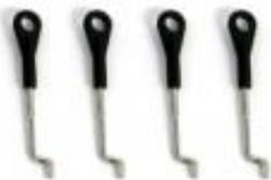
Le réglage se fait en allongeant ou en raccourcissant la bielle. La chape à rotule se visse et se dévisse. Attention de ne pas trop dévisser pour ne pas que les 2 parties se séparent en plein vol. On recommande de laisser au minimum 3 tours comme marge de sécurité.
